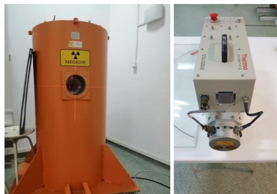
Rys.2. Izotopowe źródło neutronów ^{241}\text{Am}/\text{Be} (po lewej) oraz generator neutronów D-T (po prawej) dostępne w LWPDiR CLOR
