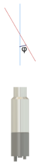
Rys. 4 Nieważkie liniowe źródło promieniowania obracające się wokół punktu będącego jego środkiem i znajdującego się na osi detektora.
