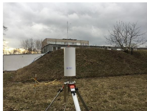
Zdjęcie 2. Sonda (SUD) podczas pomiarów środowiskowych na terenie CLOR
