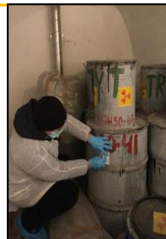
Rys. 3. Pobór wymazów z pojemników z odpadami trytowymi.
