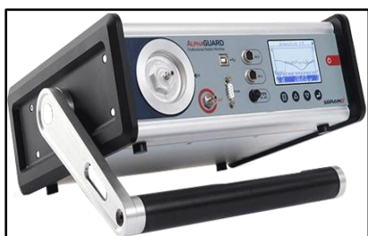
Rys. 2 i 3. Przyrządy do pomiarów pochodnych radonu: AlphaGuard (z lewej) i AlphaPm (z prawej)
