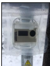
Rys. 2. Ekspozycja dozymetrów TLD
