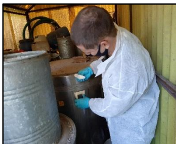
Rys. 1. Pobór wymazów z pojemników z odpadami trytowymi
