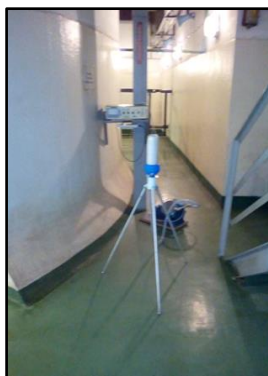
Rys. 6. Pobór aerozoli atmosferycznych przy zbiorniku R3 na poziomie -9,0 m
