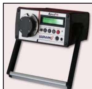
Rys. 2 i 3. Przyrządy do pomiarów pochodnych radonu: AlphaGuard (z lewej) i AlphaPm (z prawej)
